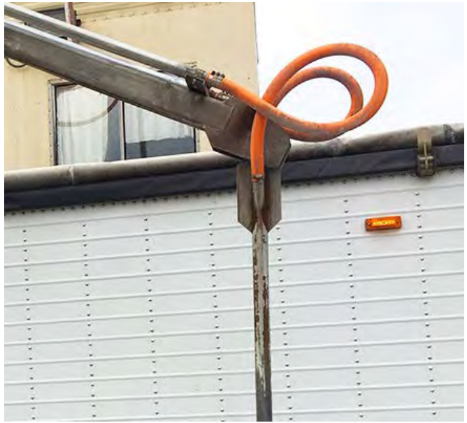
Figure 27 : Tuyau en caoutchouc pour le transport du grain et de l'air
