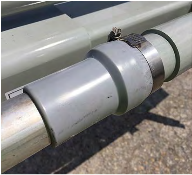
Figure 26 : Manchon de flèche à joint en caoutchouc
